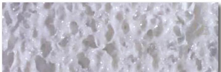
Un material “amante del agua”. Los grouts hidrofílicos prosperan con el agua y la buscan dentro de la grieta principal y sus grietas tributarias. Absorben y reemplazan el agua del sustrato mientras curan.
