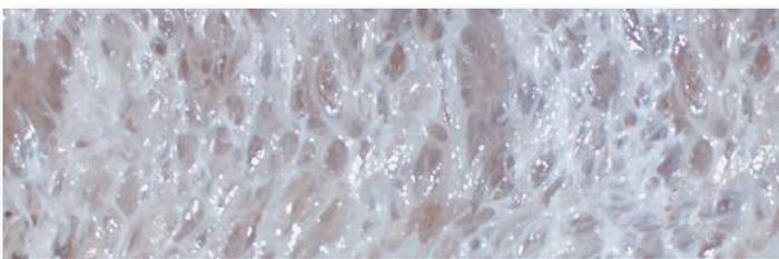
Un material “temeroso del agua”. Los grouts hidrofóbicos tienen muy poca o ninguna afinidad al agua. Repelen el agua de vuelta al sustrato mientras curan.
