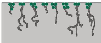
Le silicate dans EUCO Diamond Hard réagit afin de former des cristaux extrêmement durs dans les pores des surfaces en béton.
