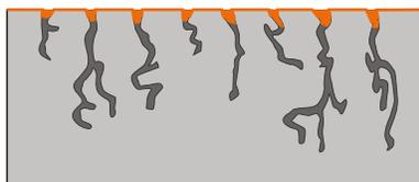
Le silicate dans EUCO Diamond Hard réagit pour créer une barrière étanche à la surface du béton.
